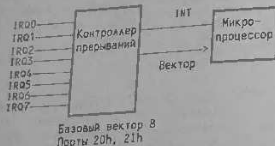
Рис. 9.1. Организация аппаратных прерываний в машинах IBM PC/XT.
